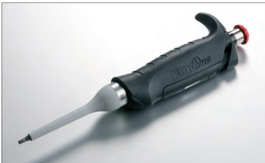
Les pipettes ErgoOne™ ont été conçues pour le prélèvement et l'évacuation précis de liquides selon le principe de déplacement d'air. Le volume pipeté est sélectionné à l'aide d'un mécanisme de réglage innovant et simple à utiliser, qui évite tout dérèglement non souhaité du volume utile pendant le pipetage.
